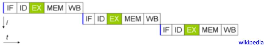
Séquençage des instructions dans un processeur sans pipeline. Il faut 15 cycles pour exécuter 3 instructions.
