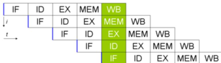
Séquençage des instructions dans un processeur doté d'un pipeline à 5 étages. Il faut 9 cycles pour exécuter 5 instructions. À  $t = 5$ , tous les étages du pipeline sont sollicités, et les 5 opérations ont lieu en même temps.
