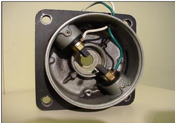
Les balais assurent la liaison électrique ( contact glissant ) entre la partie fixe et la partie tournante. Pour des machines de forte puissance, la mise en parallèle des balais est alors nécessaire.
